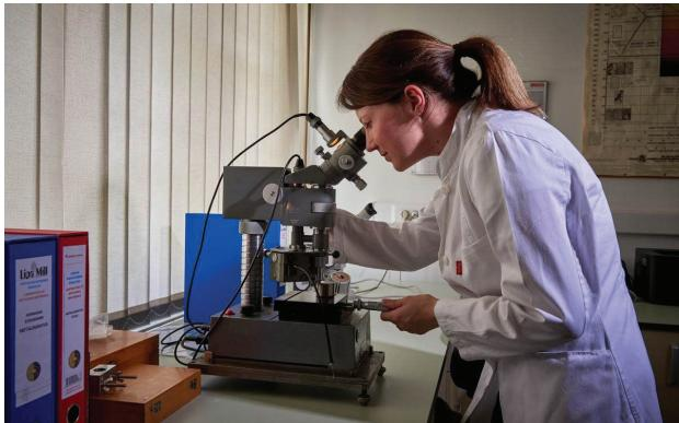
Ispitivanje mikrotvrdoće cementiranih dijelova –
