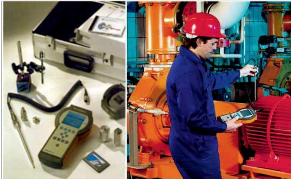
Slika 3.5. Uređaj za mjerenje vibracija
