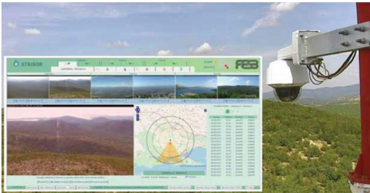
Slika 8.16. Prikaz jedne motrilačke jedinice i prikaz na zaslonu aplikacije OiV Fire Detect AI (Stipaničev, 2021)
