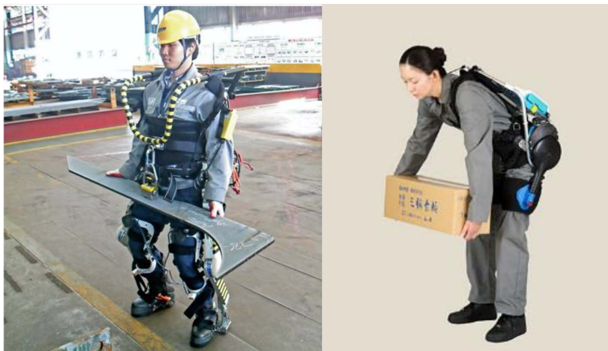
Slika 7.13. Egzoskeleti za manipulaciju teretom (izvor: Daewoo, Panasonic)
