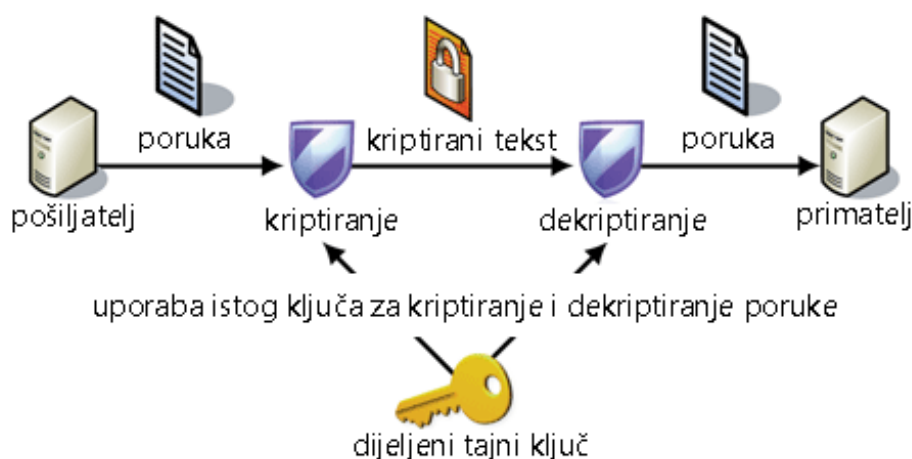
Slika 6.8. Postupak simetričnog kriptiranja (CARNet CERT, 2009)
