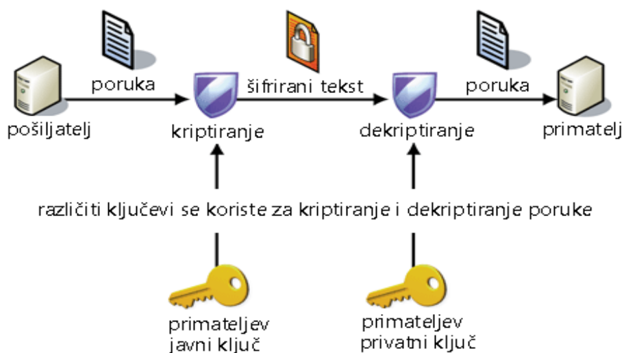
Slika 6.9. Postupak asimetričnog kriptiranja (CARNet CERT, 2009)
