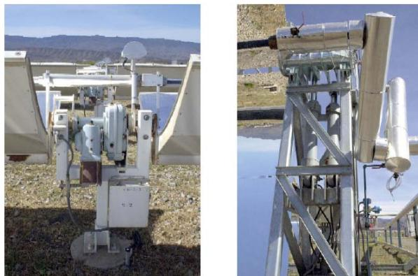
Slika 9.34.: Zakretne jedinice: elektromotor s reduktorom (lijevo), hidraulički mehanizam (desno)
