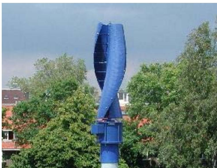
Slika 10.2.11. Spiralna Savoniusova vjetroturbina
