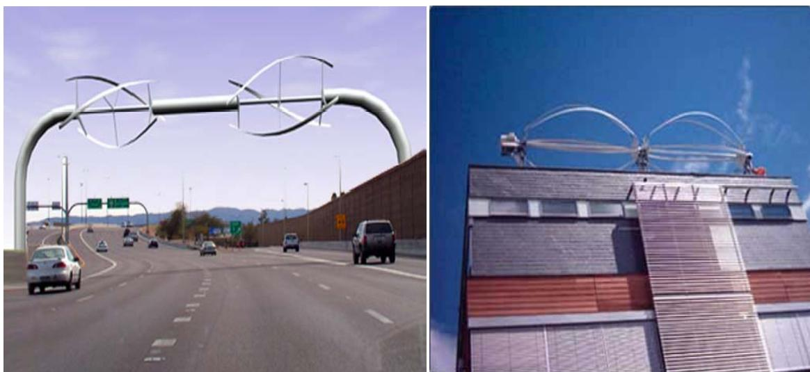
*Slika 10.2.8. Horizontalne izvedbe Darrieusovih vjetroturbina*
