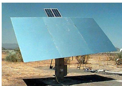
Slika 9.59.: Heliostat (Hellas 01) s vlastitim napajanjem putem fotonaponskih čelija
