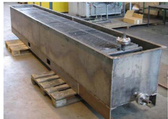
Slika 9.21.: Indirektni toplinski spremnik s fazno promjenjivim materijalom
